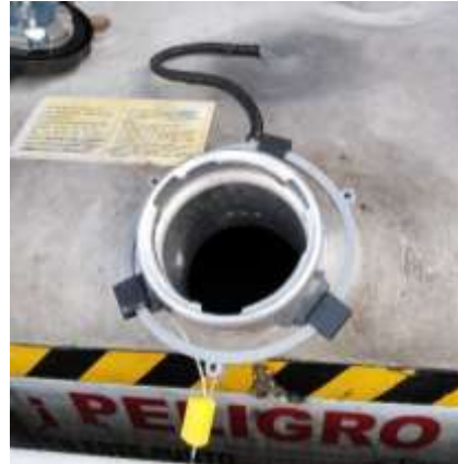
Instalación de RFID en camiones
